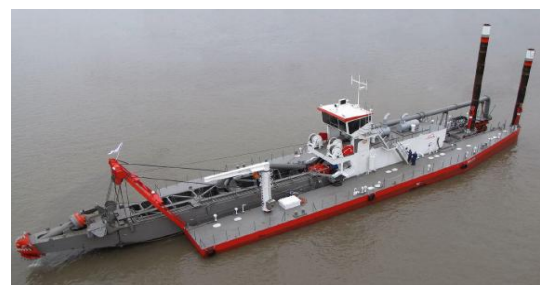
Прилог бр. 8: ИНС Рефулерни багер за шљунак, H_{kmax} = 40\text{--}45\text{ m}
