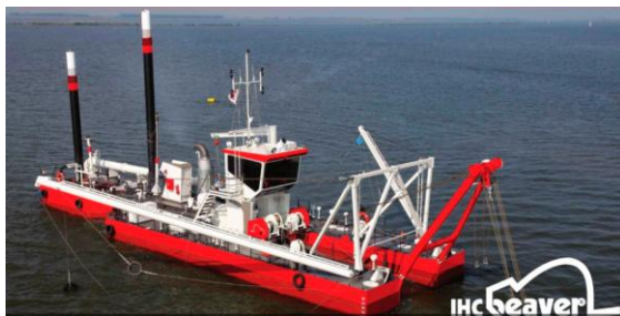
Прилог бр. 7: ИНС Рефулерни багер за песак, H_{kmax} = 14\text{ m}
