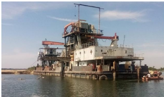
Прилог бр. 5: Багер ведричар “Калник” H_{kmax} = 22\text{ m}
