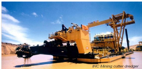
Прилог бр.9: IHC Рефулерни багер за угаљ, H_{kmax} = 60\text{ m}
