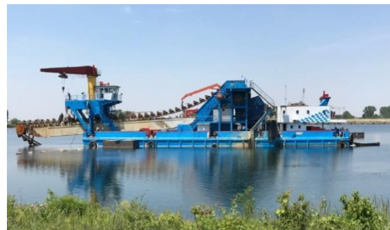
Прилог бр. 6: Багер ведричар “Црни”, H_{kmax} = 26\text{ m}
